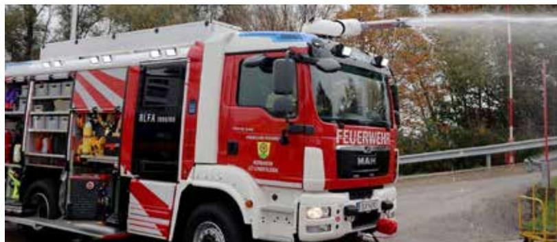
Der innengesteuerte Wasserwerfer im Betrieb.
